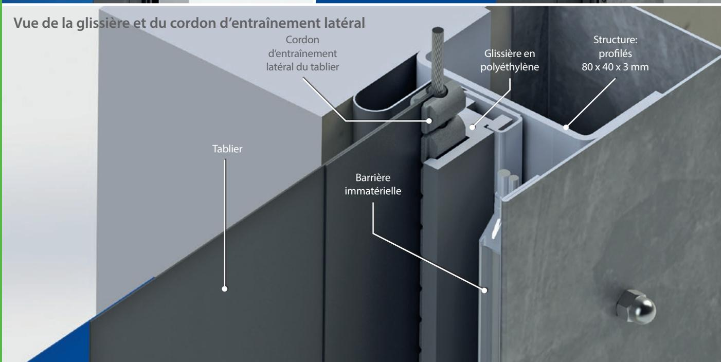
La E-231 EXT peut obtenir une certification de classe de vent 4. Elle est équipée en standard d'une barrière immatérielle. Grâce à la technologie Gravité, la porte extérieure Dynaco E-231 EXT protège vos installations du vent, de la pluie, de la neige, de la saleté et des variations de température.
