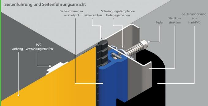
Das Dynaco D-211 ist ein kompaktes Hochgeschwindigkeits-Rolltor mittlerer Leistung mit einem vollständig flexiblen Vorhang und einer weichen Unterkante, die eine einfache Bedienung und eine hervorragende Abdichtung gewährleisten.
