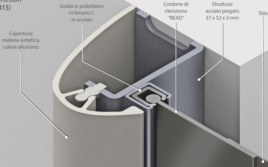
Le porte di emergenza Dynaco D-313 e M2 sono state progettate per funzionare come un'uscita di emergenza interna. Offrono tutti i vantaggi dei portoni ad alta velocità Dynaco.
