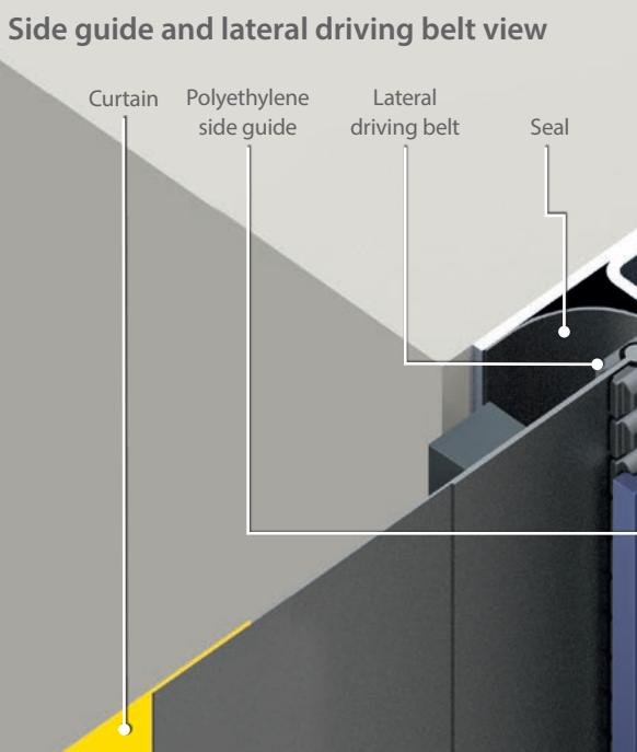
Certificată pentru 2 milioane de cicluri, Dynaco D-6 vă protejează instalațiile împotriva vântului, ploii, zăpezii, murdăriei și temperaturilor extreme. Atât viteza de operare, cât și etanșarea perfectă îmbunătățesc fluxurile de trafic, oferind în același timp confort angajaților, control asupra mediului și economii de energie.
