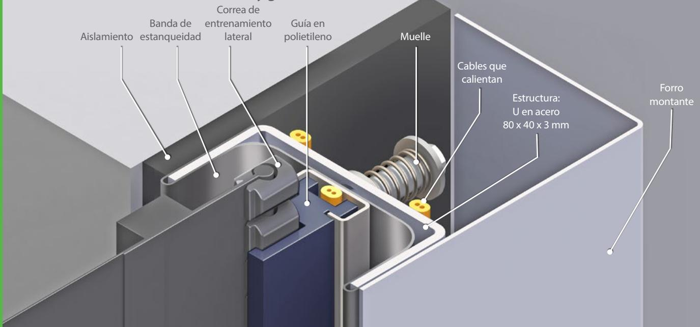
Con la tecnología Push-Pull, la Dynaco M2 FREEZER se ha diseñado para evitar puentes térmicos y reducir la infiltración de humedad. Opcionalmente, se puede incorporar una cortina aislante para ahorrar aún más energía.
